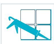
Vzniklé mezery mezi zdí a panelem vyplňte nízko-expanzní montážní pěnou.
